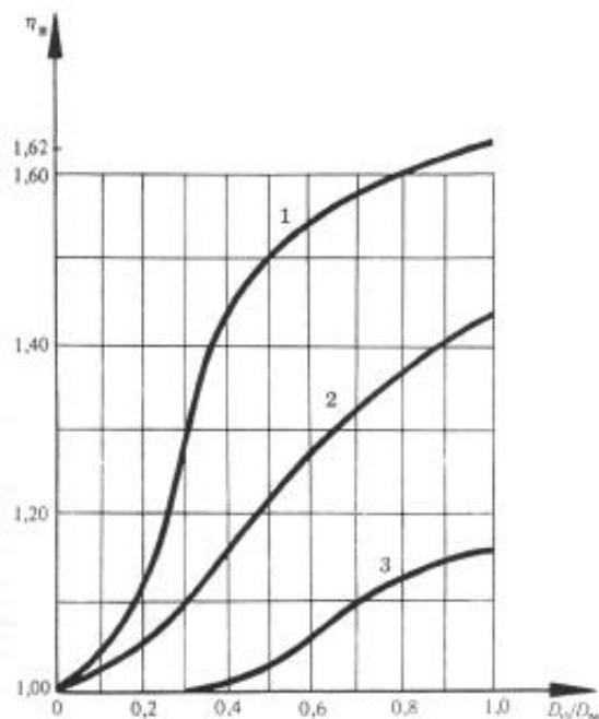
1 - для сварных без усиливающих накладок; 2 - для штампованных и штампосварных; 3 - для тройников с усиливающими накладками
